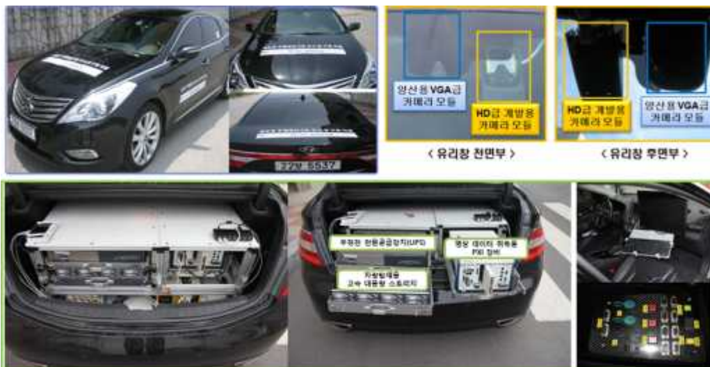
<그림 5> 1M급 전방단안카메라 기반 실도로 주행영상DB 구축시스템(그랜저 HG)
