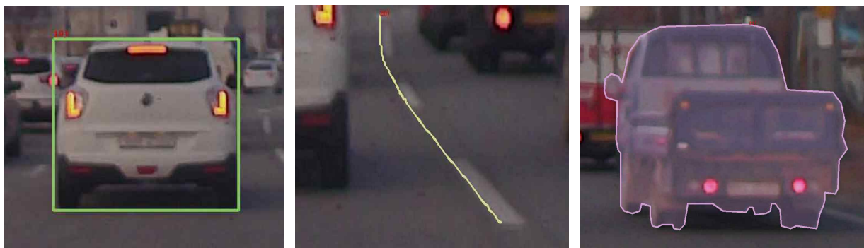
<그림 6> 학습데이터 생성 타입(좌: BoundingBox, 중: Spline, 우: Polygon)
