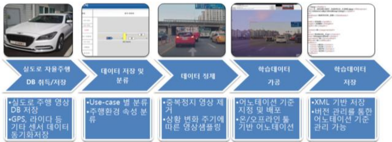
<그림 5> 실도로 자율주행 DB취득 및 가공 단계
