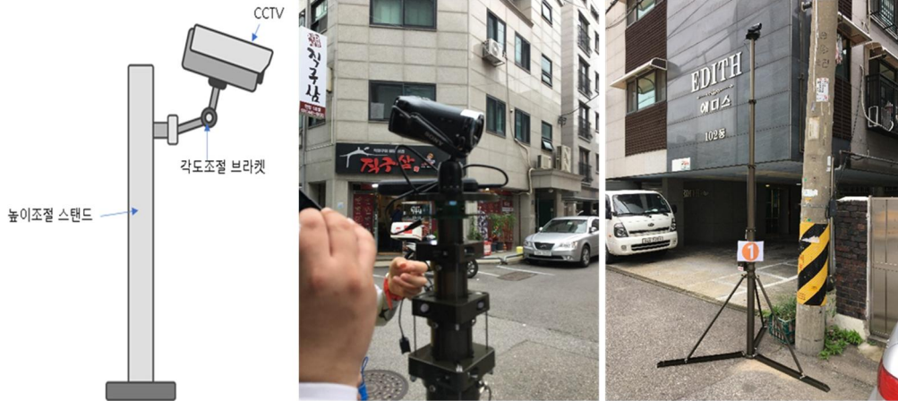
그림 8 촬영용 CCTV 장치 예시 및 기제작 시제품 모습
